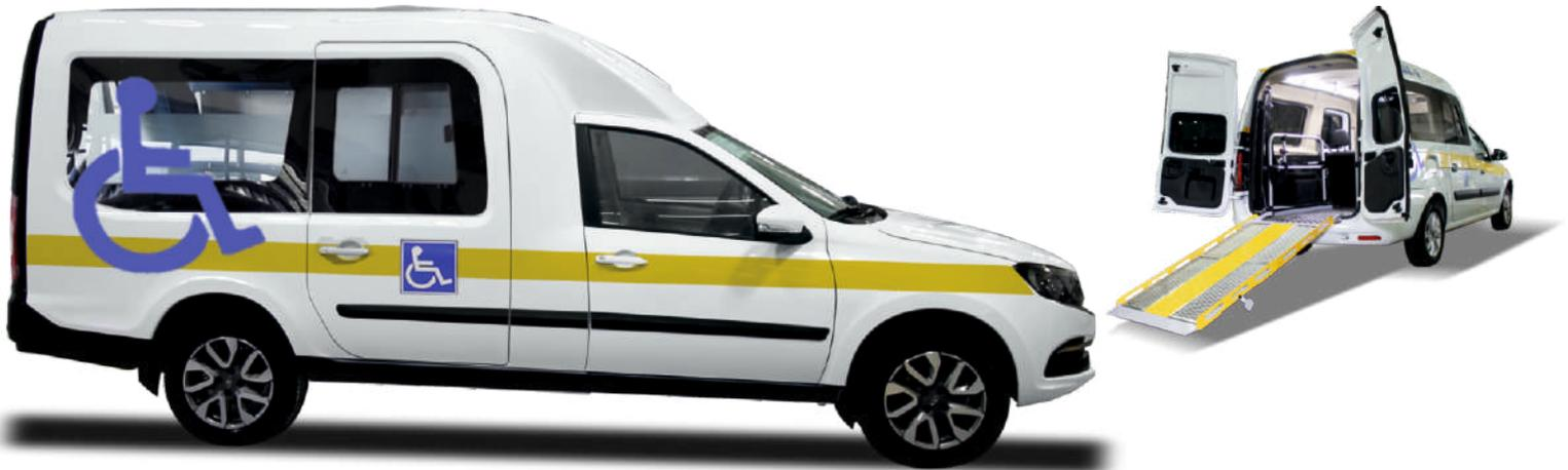
Автомобиль для перевозки двух инвалидов-колясочников: один размещается в кресле-коляске в салоне, второй на переднем пассажирском сиденье, оборудованном поворотно-выдвижным механизмом. Для удобства размещения у автомобиля увеличена длина до 4970 мм, высота до 1930 мм, увеличены задняя распашная и боковые двери.
